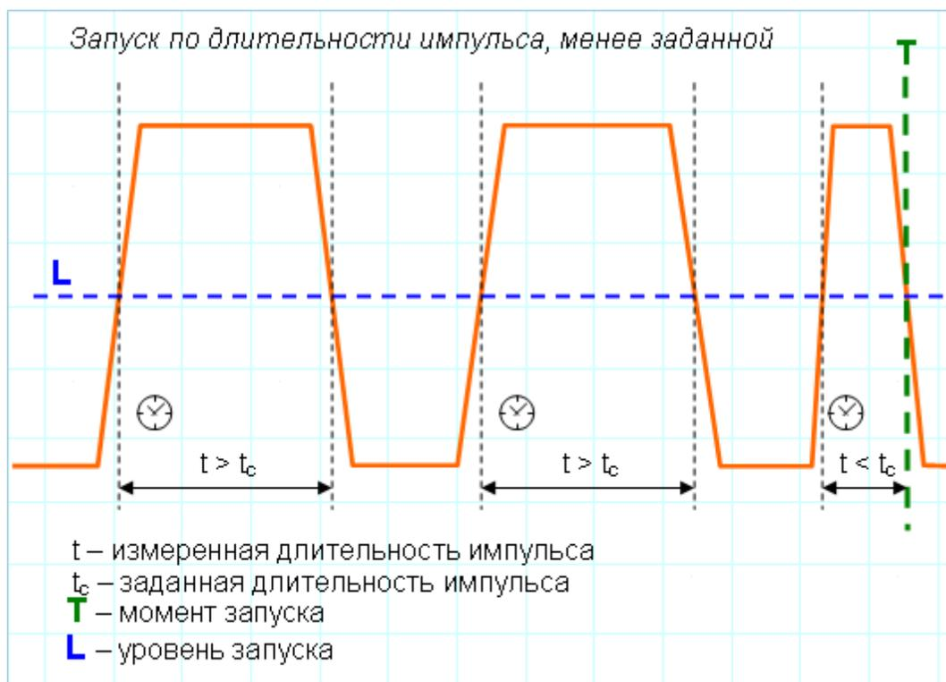
Этот режим синхронизации хорош для обнаружения аномалий в потоке импульсов, длительность которых не должна выходить из известных пределов. Указав условием запуска по импульсам с длительностью меньше или больше указанных границ мы увидим на экране искомые сбои или убедимся в их отсутствии (если система запуска перестанет срабатывать).
