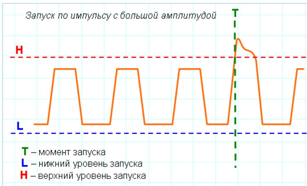
Следующий рисунок показывает обнаружение запредельного выброса в исследуемом сигнале.
