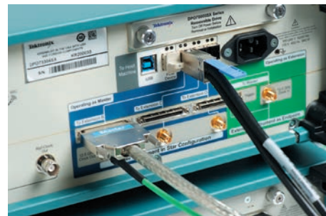
Рис. 9. Ведущий модуль (Master) — подключение синхронизирующих кабелей в ведущий модуль
