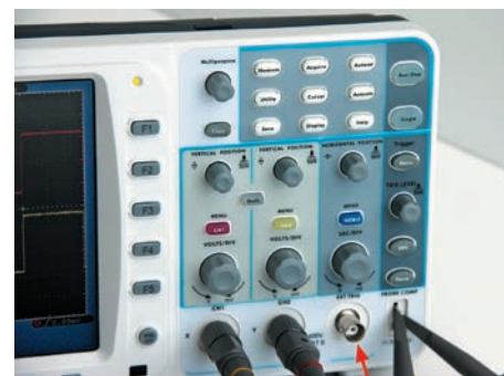
Рис. 1. Вход внешней синхронизации на осциллографе АКТАКОМ ADS-2332 (Ext TRIG)
