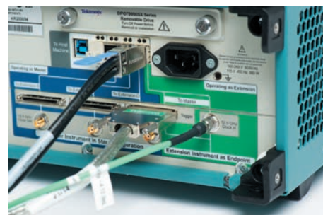
Рис. 10. Подключение шин синхронизации в ведомый модуль DPO70000SX
