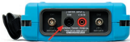
Рис. 2. В портативном осциллографе АКТАКОМ серии ADS-4xxx вход внешней синхронизации (EXTERNAL TRIGGER) совмещен с общим входом встроенного мультиметра (METER INPUT – COM)
