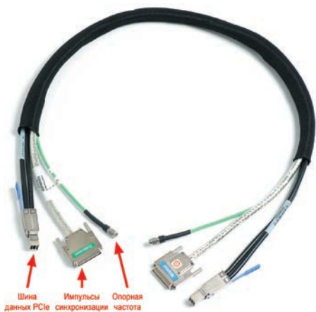
Рис. 7. Кабельная сборка UltraSync, обеспечивающая передачу синхромпульса (TRIGGER), опорной частоты (CLOCK) и шины данных (PCIe bus) между модулями DPO70000SX. Разъем, помеченный голубым, подключается к ведущему модулю, а помеченный зеленым — к ведомому
