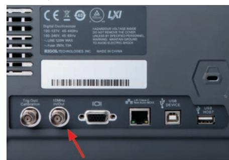
Рис. 5. Вход внешнего опорного генератора в осциллографе RIGOL в серии MSO4000 совмещен с выходом опорного генератора, что позволяет использовать осциллограф в многоканальной системе как в качестве ведущего, так и как ведомого
